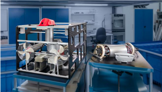
DEDAVE Tiefentaugliches, autonomes Unterwasserfahrzeug für vielfältige Explorations- und Inspektionsaufgaben.
